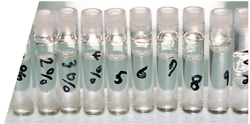
Gélification d'une solution de cellulose dissoute dans LiCl/DMAc par ajout de volumes croissants d'eau
